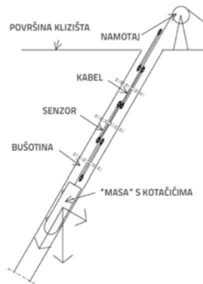
Slika 5. Princip mjerenja ekstenzometrom [29]
