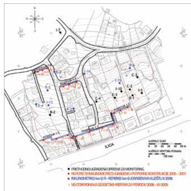
Slika 15. Klizište Grmoščica, mjerna oprema ugrađena za vrijeme i nakon sanacije
