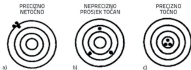
Slika 10. Shema tumačenja točnosti i preciznosti prema Dunclicliffu [29]
