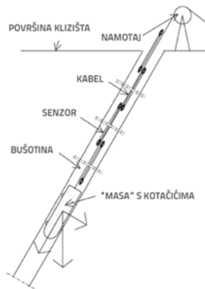
Slika 5. Princip mjerenja ekstenzometrom [29]
