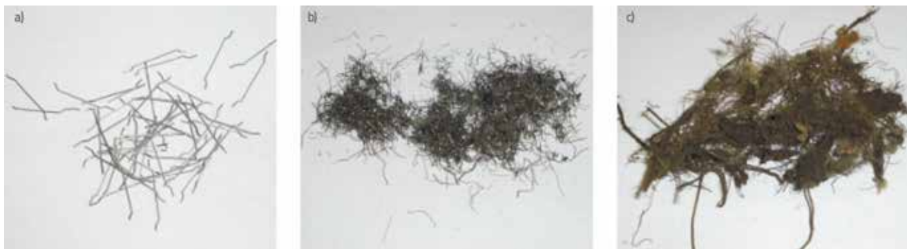
Slika 7. Vrste čeličnih vlakana za pripremu mikroarmiranih betona: a) industrijska vlakna; b) reciklirana vlakna iz automobilskih guma, pročišćena; c) reciklirana vlakna iz automobilskih guma, nepročišćena
