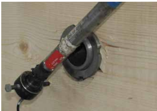
Slika 9. Deformacija srednjeg priključka druge rešetke
