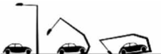
Slika 10. Ponašanje visokoapsorbirajućeg stupa [5]
