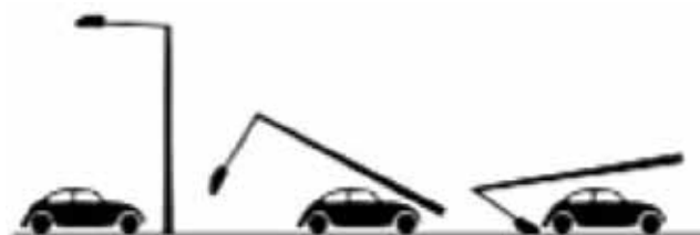
Slika 5. Ponašanje stupa koji ne apsorbiraju energiju [5]
