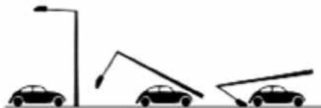
Slika 5. Ponašanje stupa koji ne apsorbiraju energiju [5]
