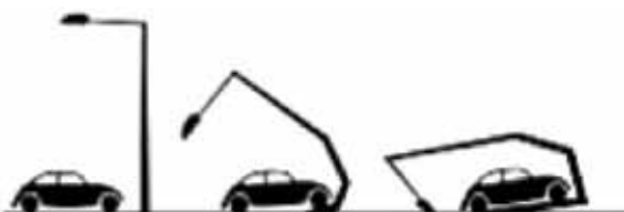
Slika 10. Ponašanje visokoapsorbirajućeg stupa [5]
