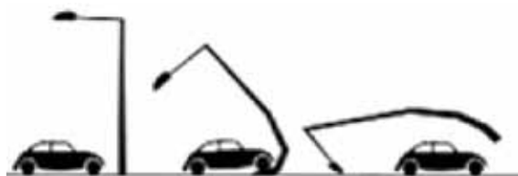
Slika 16. Ponašanje stupova koji apsorbiraju malo energije [5]
