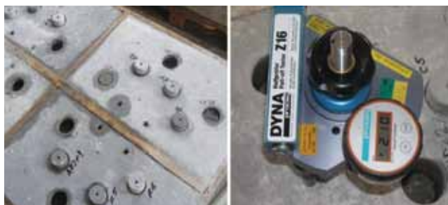
Slika 9. Provođenje ispitivanja prionljivosti reprofilijskog sustava na betonskoj podlozi otkidanjem ( Pull off test )
