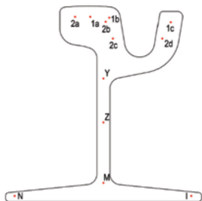
Slika 16. Pozicije mjerenja tvrdoće u poprečnom presjeku tračnice
