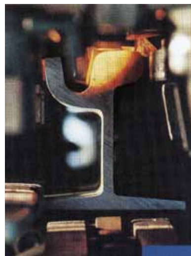
Slika 2. Termička obrada glave žljebaste tračnice
