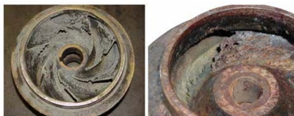
Slika 2. Tipična kavitacijska oštećenja rotora centrifugalnih crpki [7], [8]
