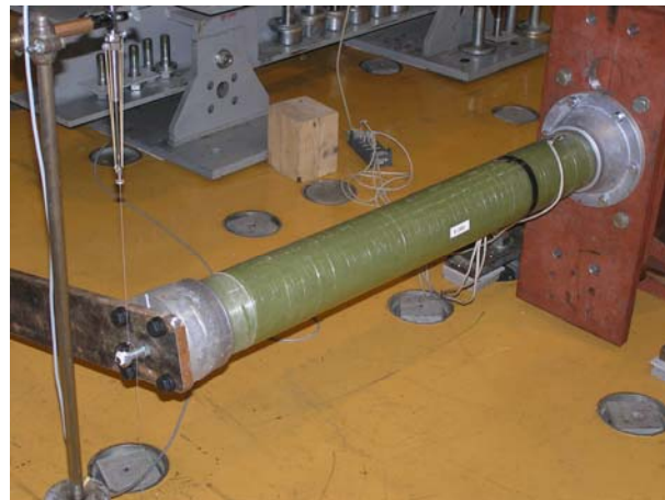
Slika 12. Uredaj i oprema pri ispitivanju cijevi pri složenom opterećenju
