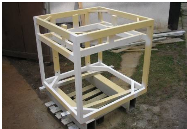
Slika 8. Postolje ćelije velikog edometra
