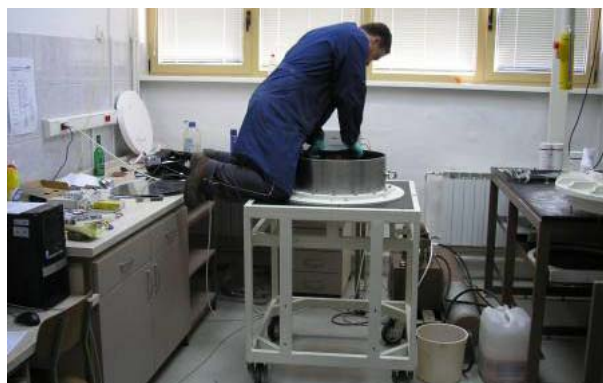
Slika 19. Zbijanje uzorka vlastitom težinom tijela
