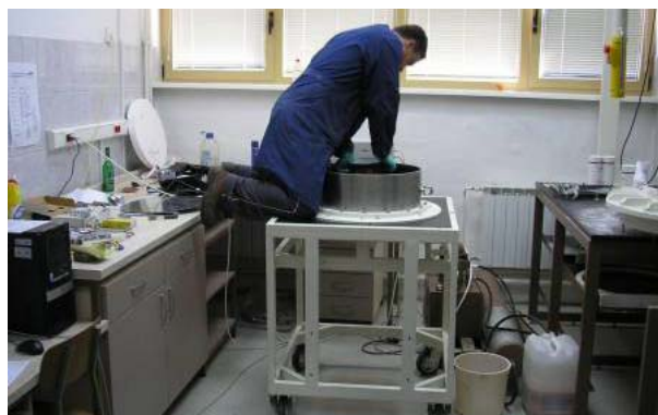
Slika 19. Zbijanje uzorka vlastitom težinom tijela
