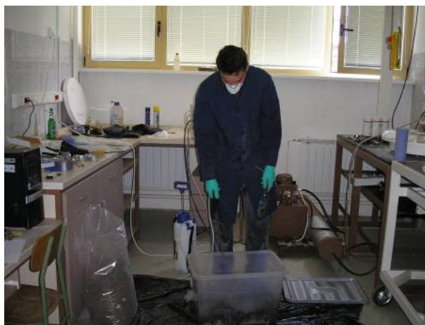
Slika 16. Raspršivanje vode vinogradarskom prskalicom
