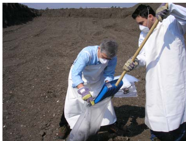
Slika 1. Uzorkovanje mehaničko-biološki obrađenog otpada
