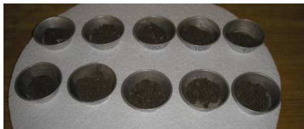
Slika 3. Uzorci otpada za određivanje ravnotežnog sadržaja vlage otpada
