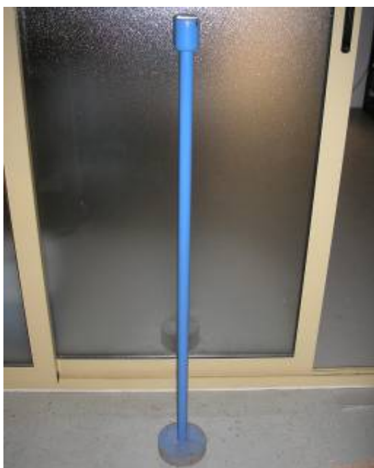
Slika 20. Uteg mase 11,2 kg za dinamičko zbijanje uzorka
