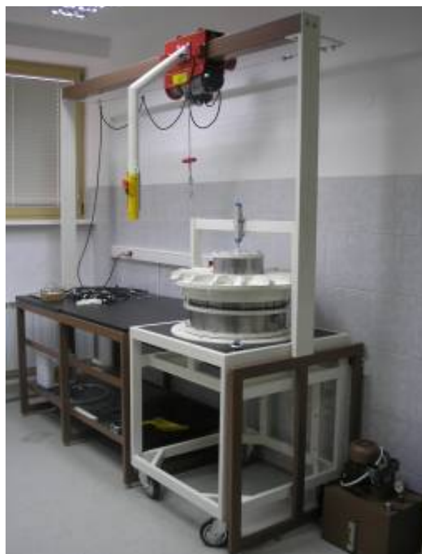
Slika 7. Novi veliki edometar na Geotehničkom fakultetu Sveučilišta u Zagrebu
