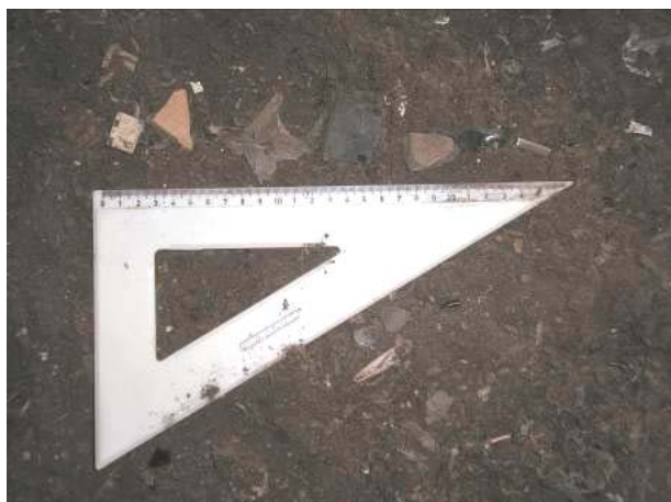
Slika 5. Zrna najvećeg promjera u uzorcima otpada
