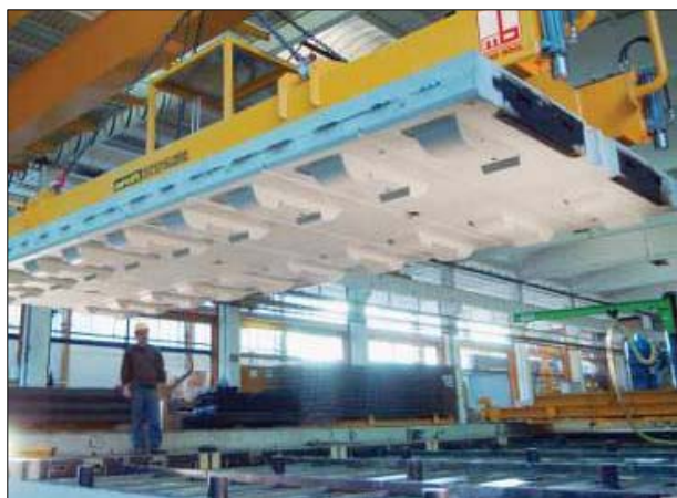
Slika 15. Tvornička proizvodnja predgotovljenih ploča [13]
