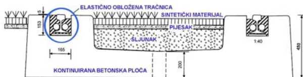
Slika 20. Poprečni presjek kolosiječnog sustava „INFUNDO“ [1]
