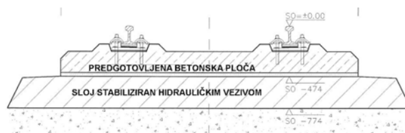
Slika 14. Poprečni presjek pločastog kolosijeka tipa „Bögl“ [9]
