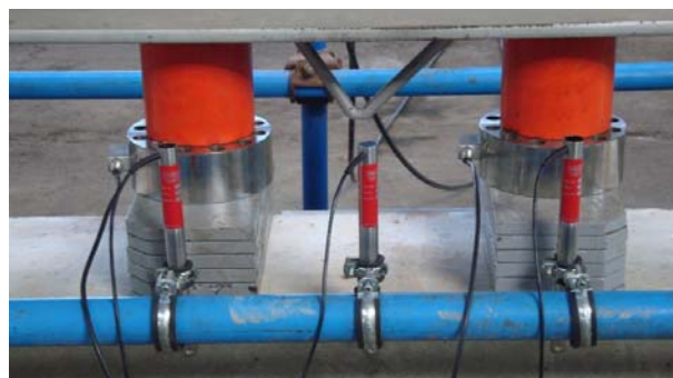
Slika 7. Mjerenje pomaka grede pri unosu opterećenja
