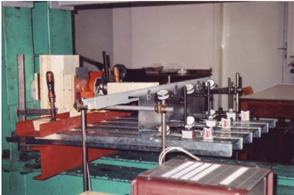
Slika 3. Eksperimentalno određivanje rotacijske krutosti C_{D,A}
