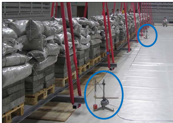
Slika 18. LVDT za mjerenje pomaka
