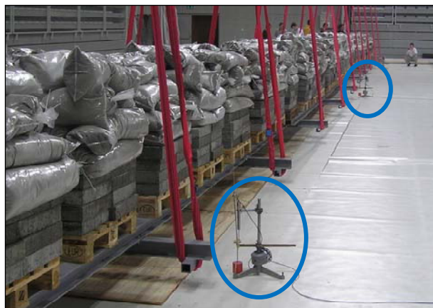
Slika 18. LVDT za mjerenje pomaka
