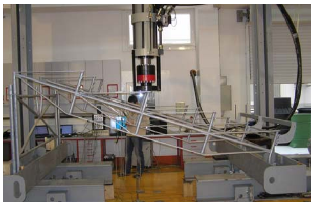
Slika 8. Ispitivanje glavnog nosača tribina u laboratoriju
