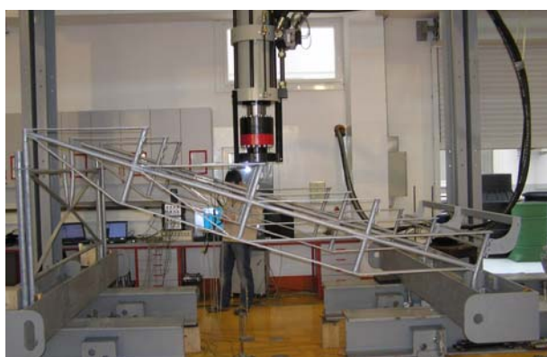
Slika 8. Ispitivanje glavnog nosača tribina u laboratoriju
