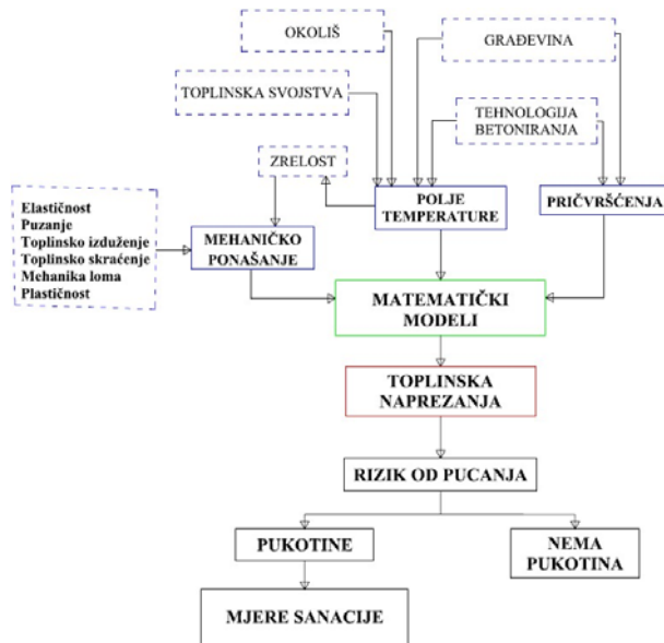
Slika 6. Shematski prikaz parametara koji utječu na toplinska naprežanja i pojavu pukotina u mladom betonu
