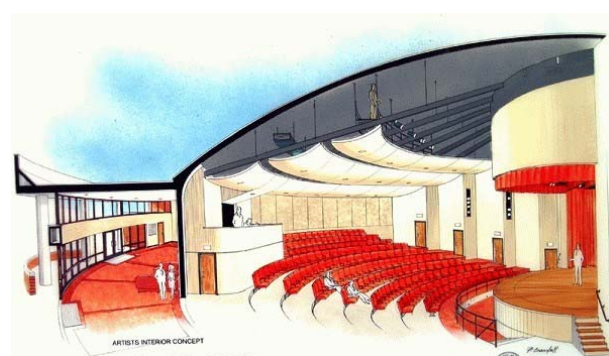
Slika 7. Gainesville Performing Arts Center, Texas, SAD, armiranobetonska kupola promjera 39,6 m; strelica 7 m; visina zida 5,5 m (tehnologija Monolithic Dome, 2005.)
