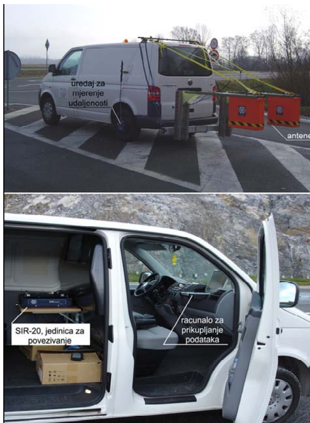
Slika 1. Sustav GPR i ispitno vozilo Zavoda za prometnice, Građevinskog fakulteta Sveučilišta u Zagrebu
