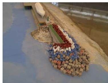
Slike 10., 11. Izgled fizikalnog modela splitske gradske luke – produljenje lukobrana ACI marine (lijevo) i glavnog lukobrana (desno) [13]
