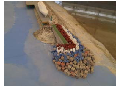
Slike 10., 11. Izgled fizikalnog modela splitske gradske luke – produljenje lukobrana ACI marine (lijevo) i glavnog lukobrana (desno) [13]
