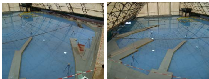
Slike 8. i 9. Izgled fizikalnog modela splitske gradske luke – pogled na sjevernu (lijevo) i južnu (desno) stranu luke [13]
