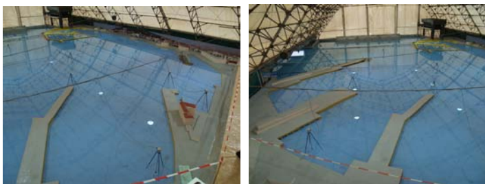
Slike 8. i 9. Izgled fizikalnog modela splitske gradske luke – pogled na sjevernu (lijevo) i južnu (desno) stranu luke [13]
