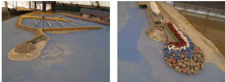
Slike 10., 11. Izgled fizikalnog modela splitske gradske luke – produljenje lukobrana ACI marine (lijevo) i glavnog lukobrana (desno) [13]
