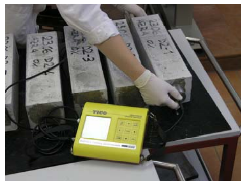
Slika 5. Određivanje dinamičkog modula elastičnosti
