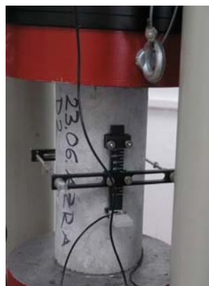
Slika 4. Određivanje statičkog modula elastičnosti
