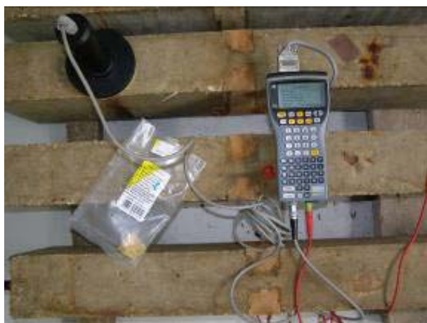
Slika 6. Mjerenje uređajem GalvaPulse
