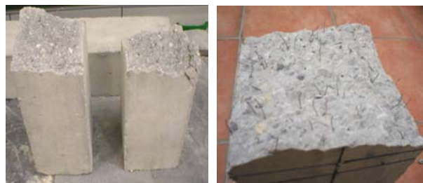
Slika 5. Slomljeni uzorak nakon ispitivanja žilavosti (lijevo) i raspodjela čeličnih vlakana u poprečnom presjeku uzorka (desno)
