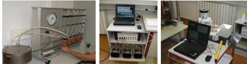
Slika 2. Metode ispitivanja plinopropusnosti, koeficijenta difuzije klorida i početnog površinskog upijanja
