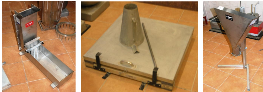
Slika 1. Metode ispitivanja samozbijajućeg betona u svježem stanju (L kutija, slump rasprostiranje i V lijevka)
