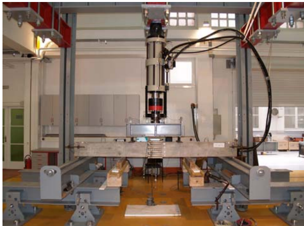
Slika 2. Uzorak grede u uređaju za ispitivanje
