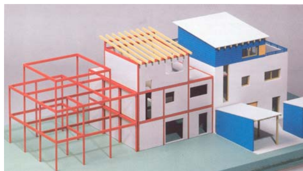
Slika 7. Faze izvedbe kuće u sustavu okvirne gradnje
