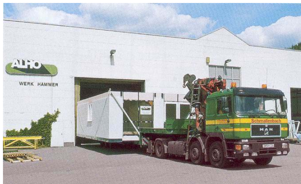
Slika 9. Otprema modula na gradilište
