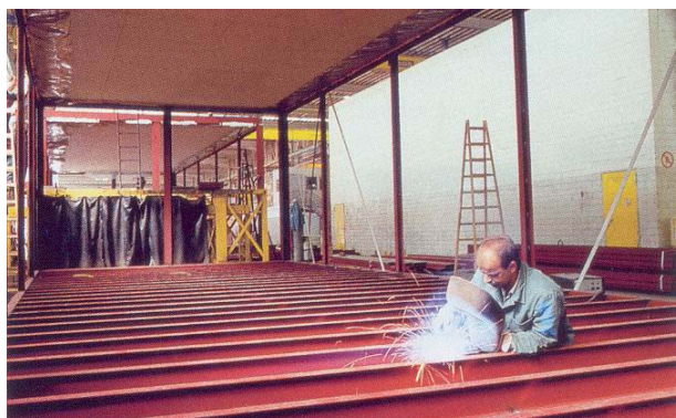
Slika 8. Izrada modula u radionici
