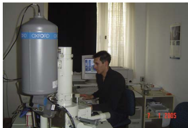
Slika 9. Analiza mikrostrukture betona scanning elektronskim mikroskopom
