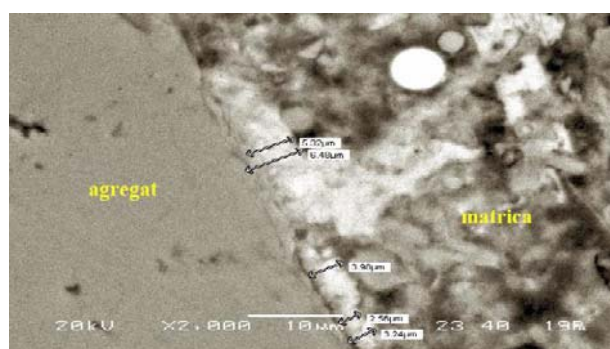
Slika 11. Sučeljak agregata i cementnog kamena na uzorku mješavine NSC
