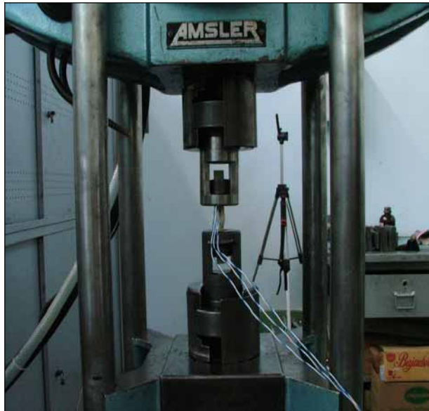
Slika 4. Ispitivanje uzorka kompozita na rastezanje
