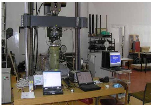
Slika 11. Ispitivanje modela cijevi pri dvoosnom stanju naprezanja
