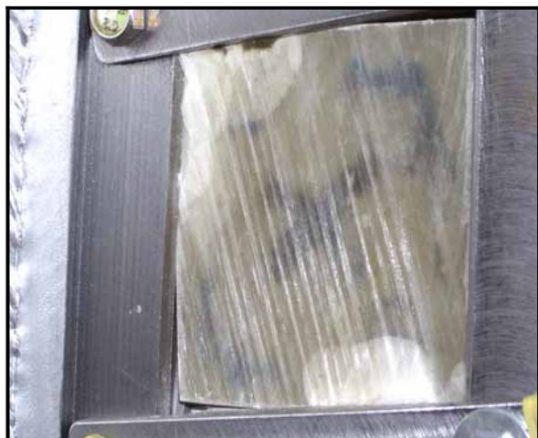
Slika 8. Ispitivanje uzorka kompozita pri čistom posmiku
