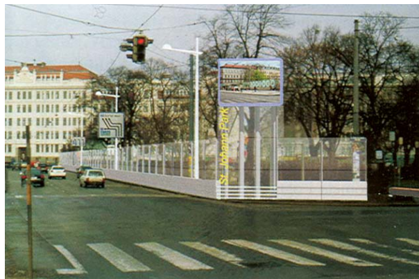
Slika 9. Prozirna barijera za zaštitu od buke [20]
