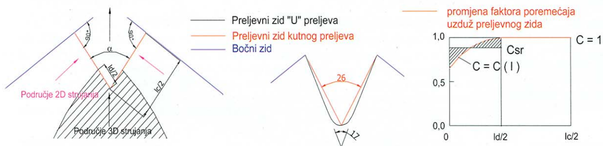
Slika 1. Shematski prikaz simetričnoga kutnoga oštrobridnoga preljeva i U preljeva s okomitim bočnim zidovima [1]
