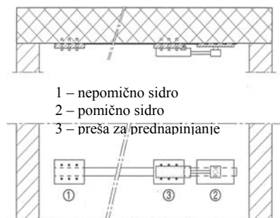
Slika 10. Sustav prednapinjanja. Nepomično pomično sidro i preša [19]
