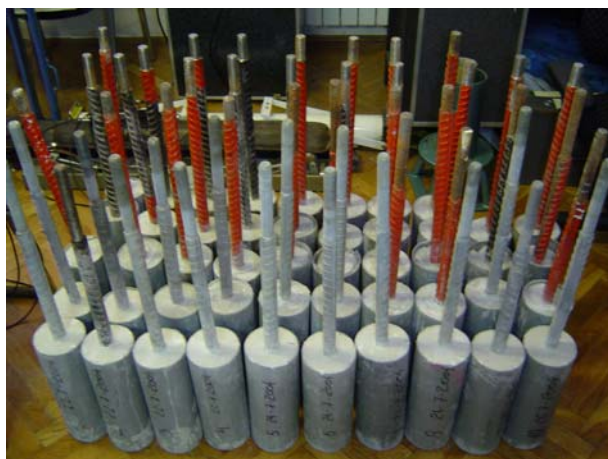
Slika 3. Uzorci štapnih sidara za ispitivanje [3]
