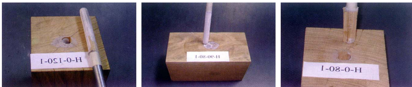
Slika 5. Tri karakteristična oblika sloma uzorka
