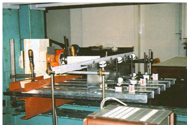
Slika 10. Eksperimentalno određivanje stupnja bočne (torzijske) krutosti
