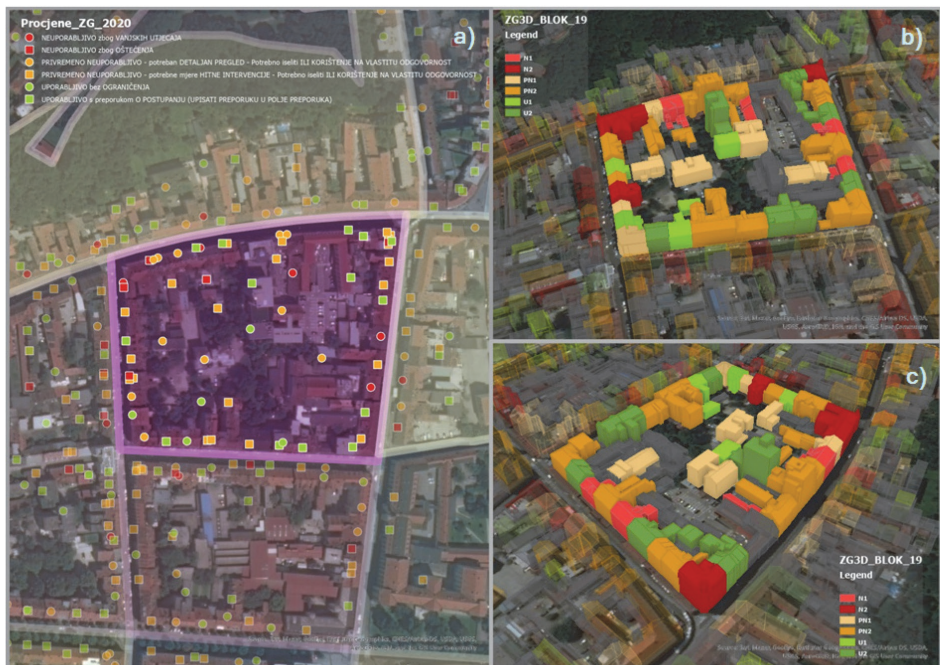
Slika 9. Blok 19: procjena uporabljivosti zgrada [1]
