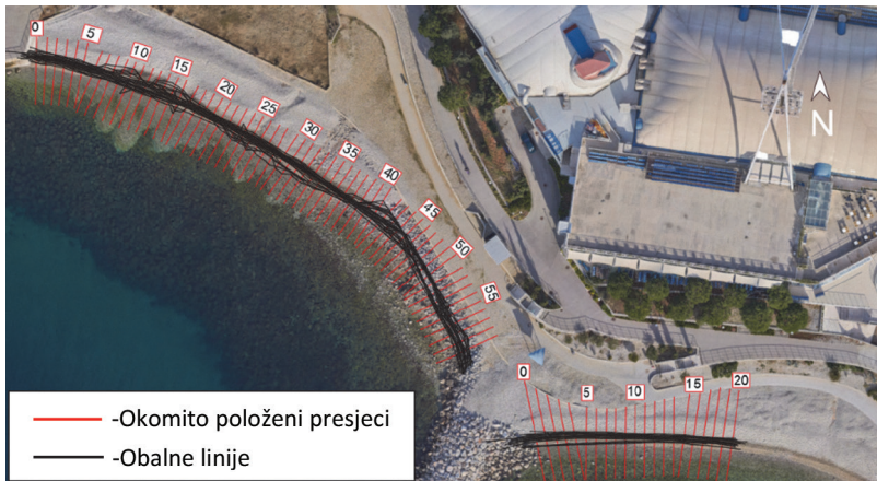
Slika 5. Okomito položeni presjeci uzduž obale za procjenu položaja obalne linije (crvene linije) i položaj obalnih linija u promatranom razdoblju prikazane u AutoCad-u (crne linije)
