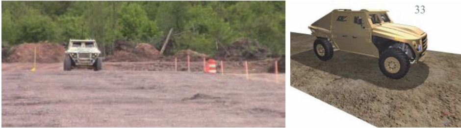
Slika 4. Usporedni prikaz terenskog ispitivanja (lijevo) i računalne simulacije (desno) [2]
