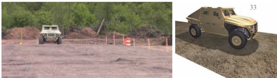
Slika 4. Usporedni prikaz terenskog ispitivanja (lijevo) i računalne simulacije (desno) [2]
