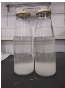
Slika 2. Pripravljene otopine natrijevog silikata - zbog izrazito egzotermne reakcije prilikom dodatka (otapanja) NaOH peleta, otopinu treba povremeno promiješati dok se temperatura ne ustali na sobnu temperaturu kako ne bi došlo do lijepljenja NaOH peleta za dno boce
