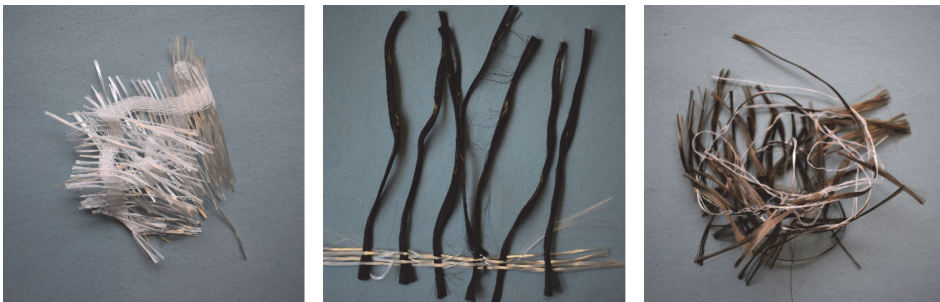
Slika 1. Otpadna vlakna dobivena u proizvodnji mrežica za građevinarstvo; s lijeva na desno: staklena, ugljična, bazaltna vlakna
