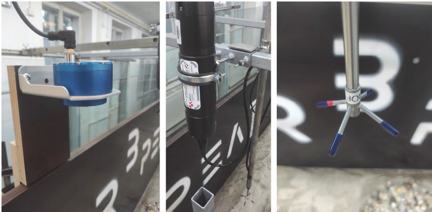
Slika 3. Geolux lx-80 mjerac razine (lijevo), Vectrino Profiler (sredina), glava VP/ADV uređaja (desno)
