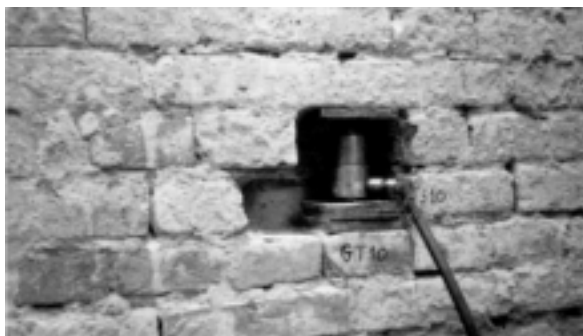
Slika 4. Način ispitivanja tlačne čvrstoće morta zida od opeke
