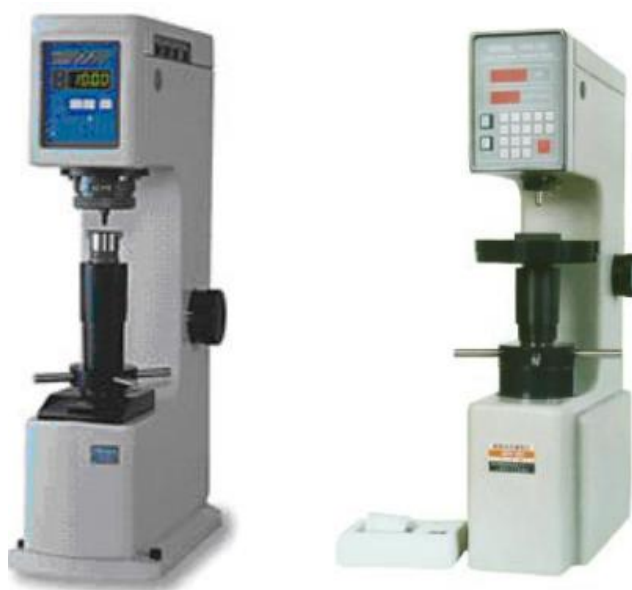
Slika 3.6 Uređaj za ispitivanje tvrdoće po Rockwellu [11]
