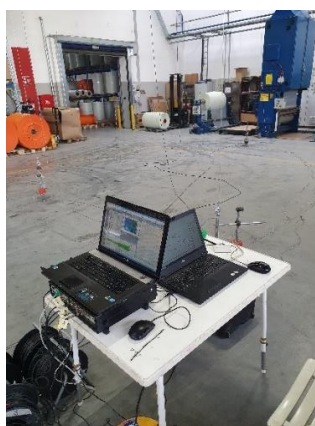
Slika 7.12 Mjerna stanica za provedbu statičkog i dinamičkog ispitivanja
