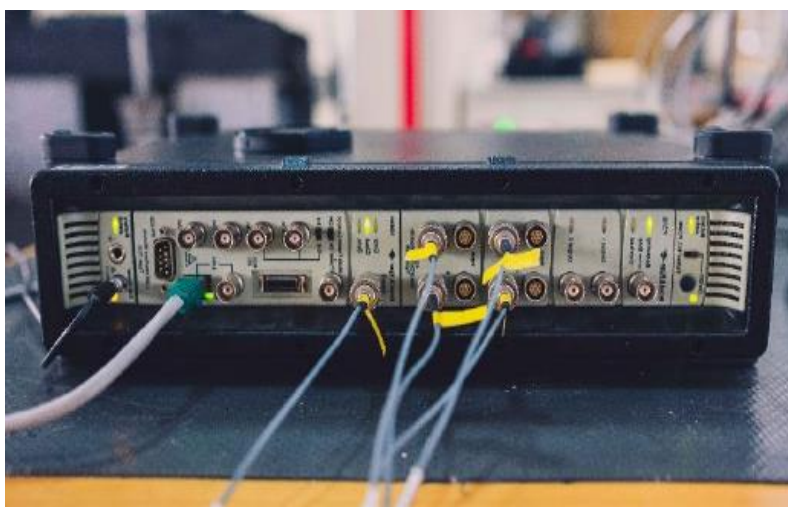
Slika 7.17 Sustav za prikupljanje podataka i analizator Bruel & Kjaer 3560C
