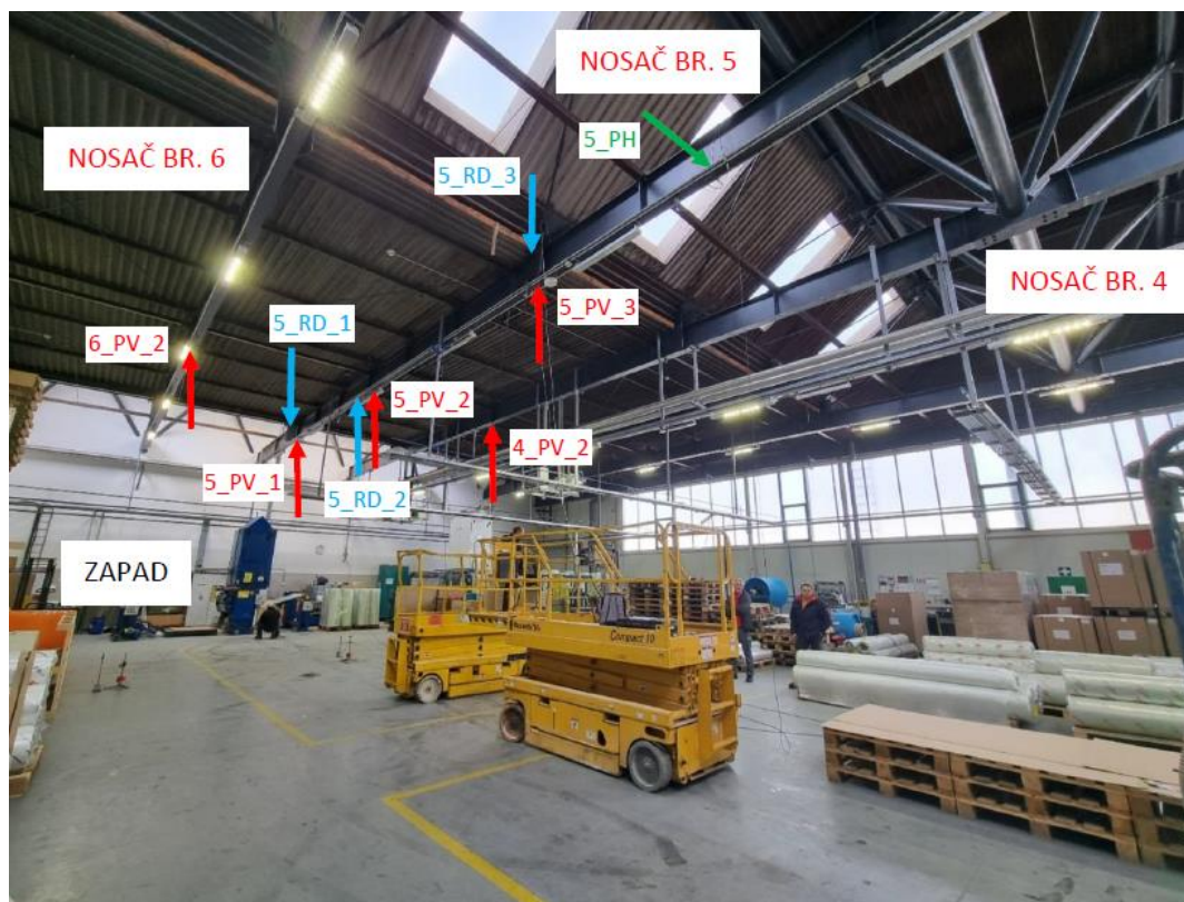
Slika 7.13 Pogled na sekundarni nosač br. 5 i susjedne nosače br. 4 i 6 sa označenim mjernim mjestima vertikalnih pomaka (oznaka PV), horizontalnog pomaka (oznaka PH) i relativnih deformacija (oznaka RD)
