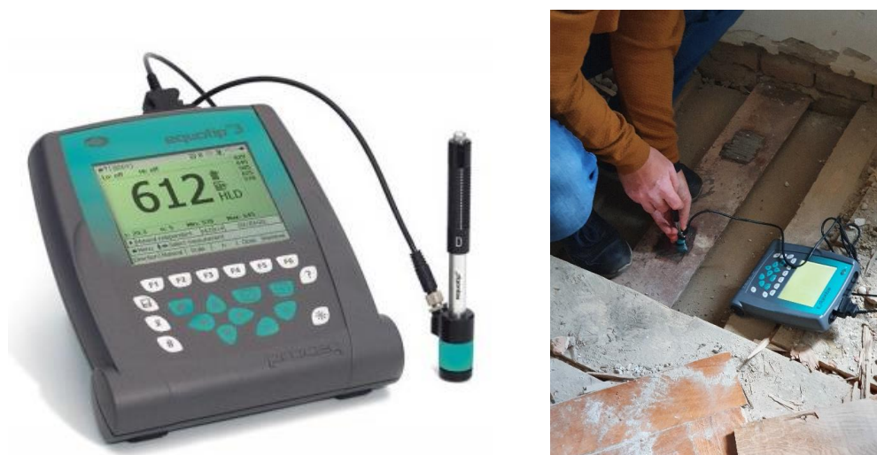
Slika 3.11 Prikaz Leeb uređaja za mjerenje tvrdoće [31]
