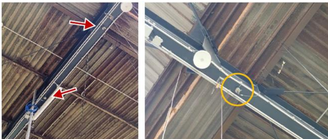
Slika 7.18 Pogled na akcelerometre za vrijeme dinamičkog ispitivanja
