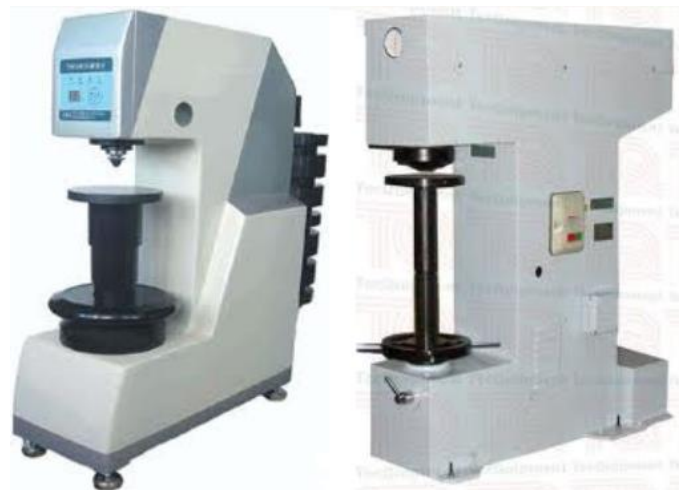
Slika 3.2 Uređaj za ispitivanje tvrdoće po Brinellu [11]
