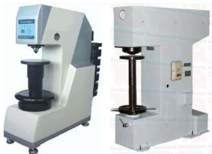
Slika 3.2 Uređaj za ispitivanje tvrdoće po Brinellu [11]
